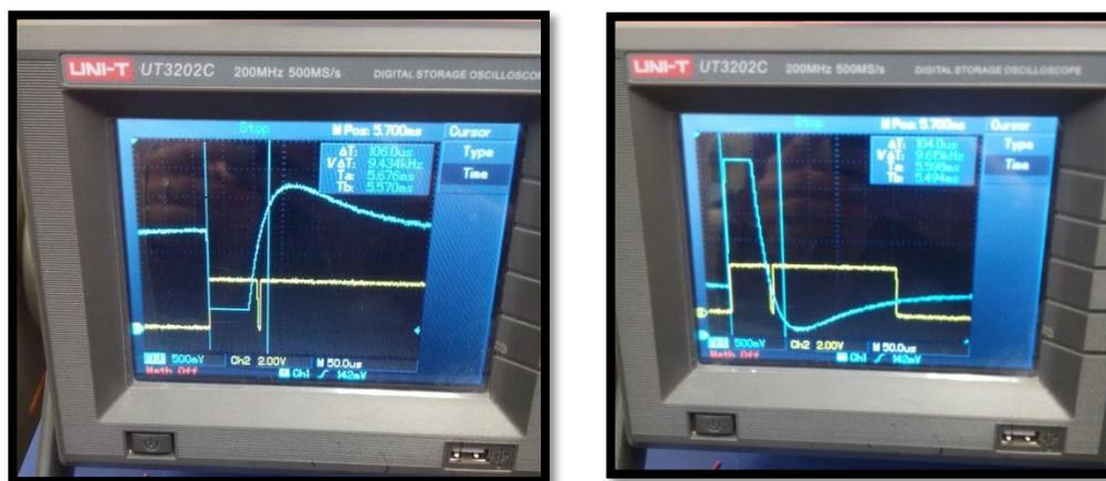
FIGURA 31. Visualización de las señales emisor receptor en el osciloscopio.
