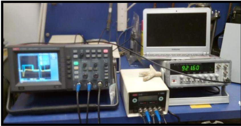
**FIGURA 25.** Equipos utilizados para medir la velocidad de propagación de ondas P.
