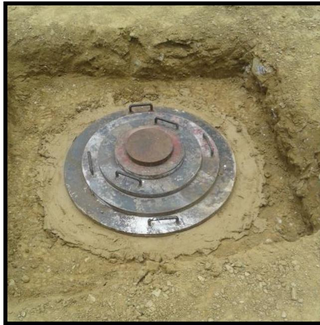
**FIGURA 47.** Platos de acero que oscilan entre 76 cm a 15 cm. imagen tomada en AISB
