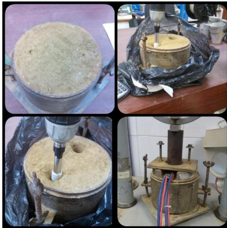
**FIGURA 34.** Experimento 4: determinación de velocidad de propagación de ondas p en suelos.
