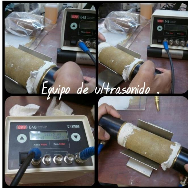
FIGURA 37. Medición de velocidad de propagación con equipo de ultrasonido
