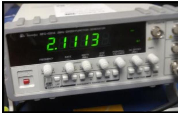
FIGURA 26. Generador de señales, valor máximo de resonancia.
