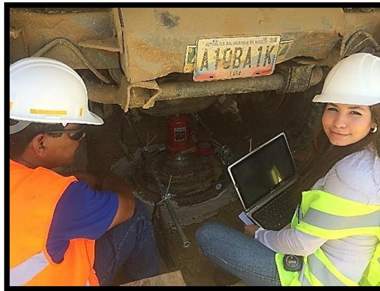
**FIGURA 49.** Determinación del módulo de reacción en campo.
