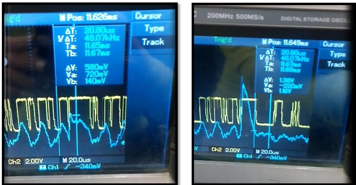
FIGURA 33. Visualización de aumento de amplitud con diferentes cargas.
