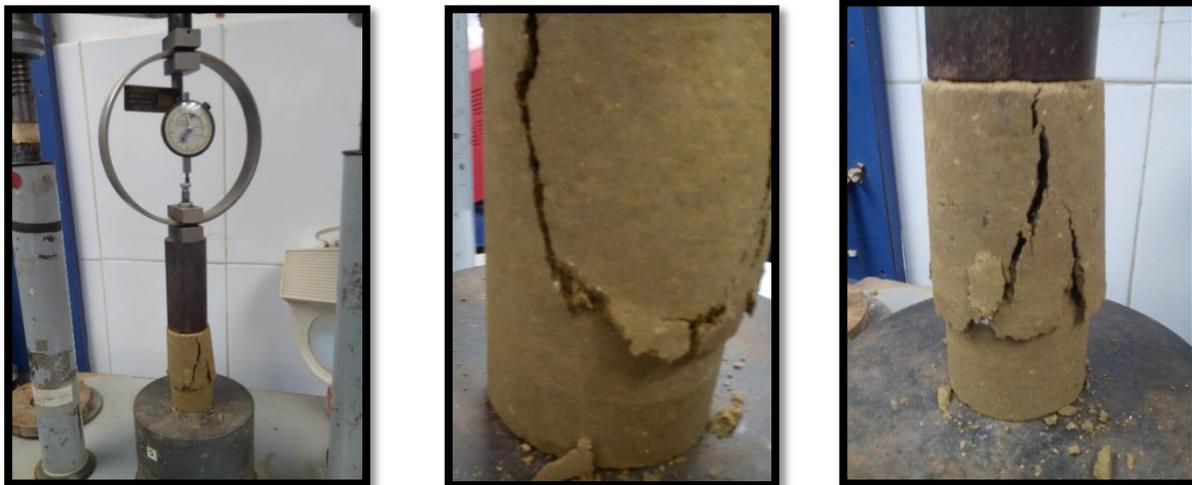
FIGURA 45. Ensayo de compresión no confinada. Tomada en laboratorio de suelos Centeno-Rodríguez y asociados
