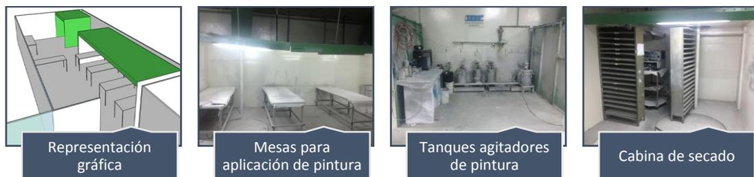
**Ilustración N°11. Área de aplicación de pintura**
