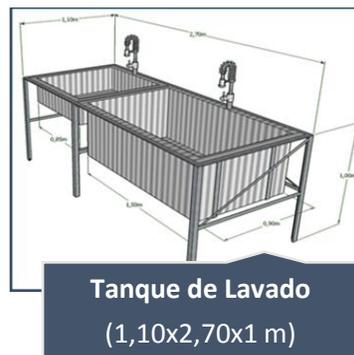
**Ilustración N°22. Propuesta de reacondicionamiento del tanque de lavado**
