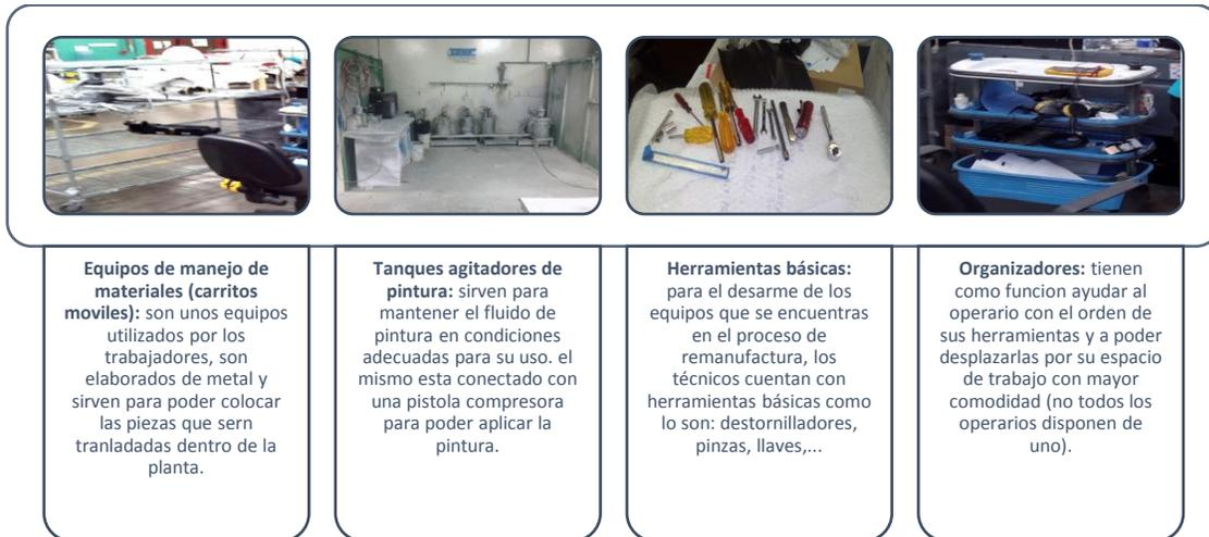
**Ilustración N°14. Herramientas y equipos utilizados en la planta**
