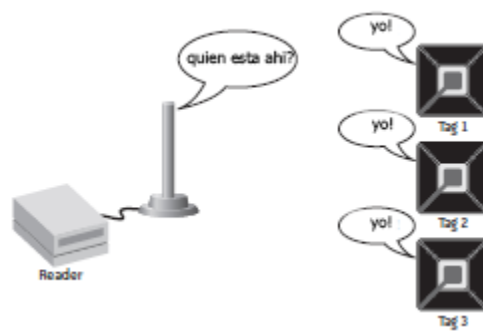
Gráfico 10 Comunicación entre el tag RFID y el lector. Tomado de (B. Glover, H. Bhat, 2006).
