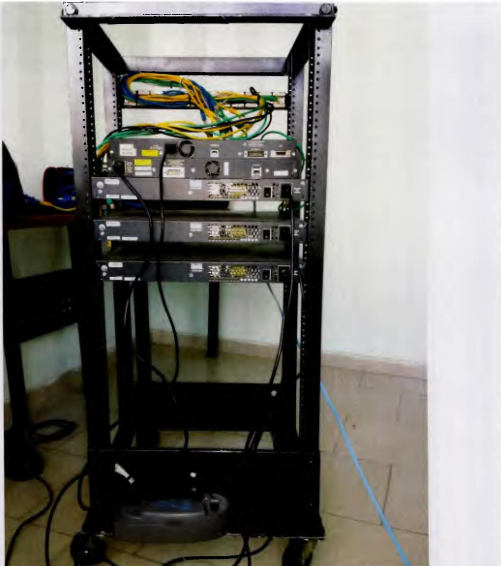
Figura 20 Rack móvil de dispositivos de red
