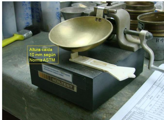
*Figura 2:* Calibración del talón del equipo de Casagrande con ayuda del ranurador, para controlar que la altura de caída de la copa sea igual a 1.00 cm.
