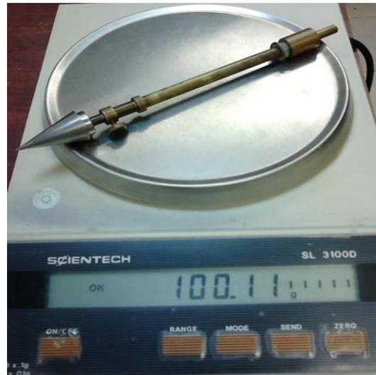
(b) Cono ensamblado con sobrecarga de 100 gr
