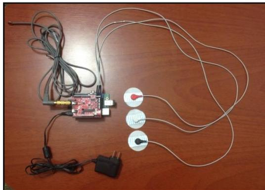
**Figura 38: Unidad de monitoreo con todos sus componentes y sensores**
