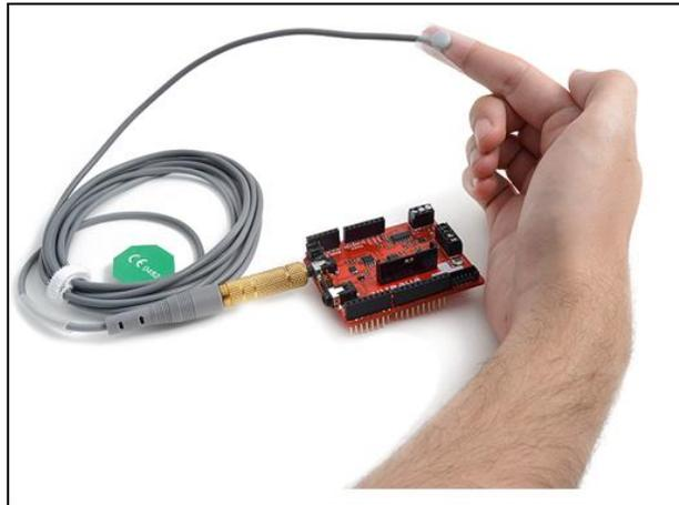
**Figura 35: Conexión del sensor de Temperatura Corporal a la e-Health Sensor Shield V2.0.**
