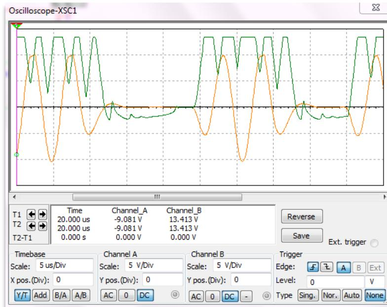
**Figura 39** Rectificación a onda completa de señal filtrada
