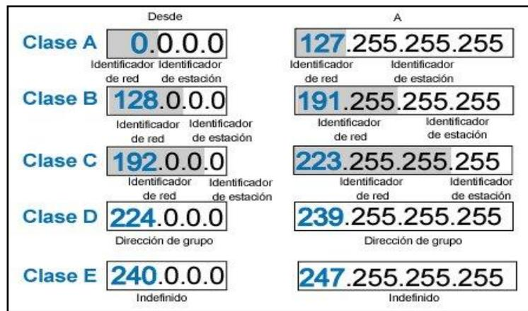
Figura 8. Clases de direcciones IP.
