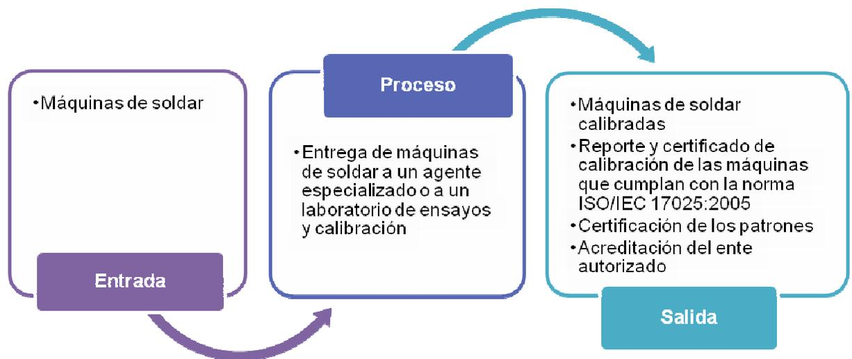
**Figura N° 13.** Proceso de Calibración de máquinas de soldar.
