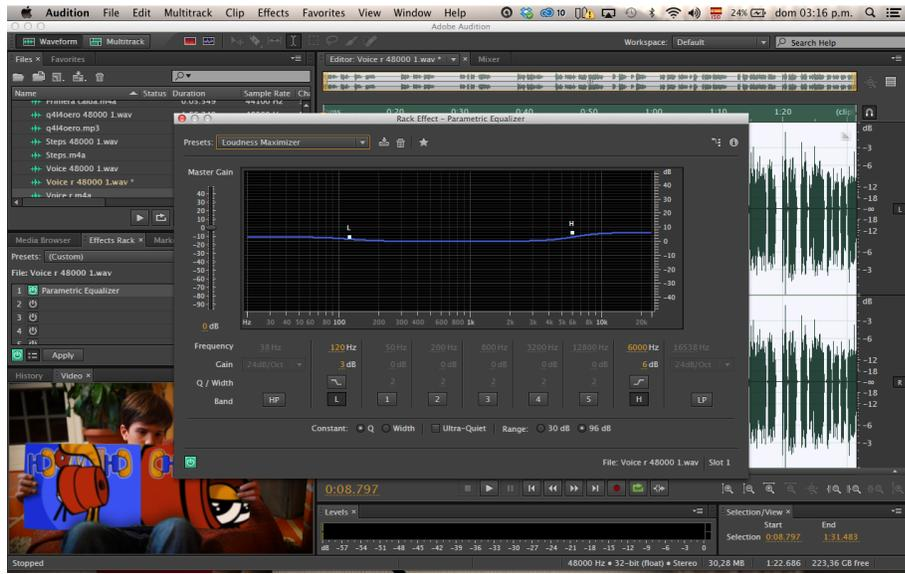
*Figura 33.* Aplicación del ecualizador paramétrico a los canales de audio.
