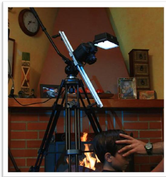
*Figura 18.* Cámara sobre un slider, que a su vez se encuentra apoyado en un trípode.
