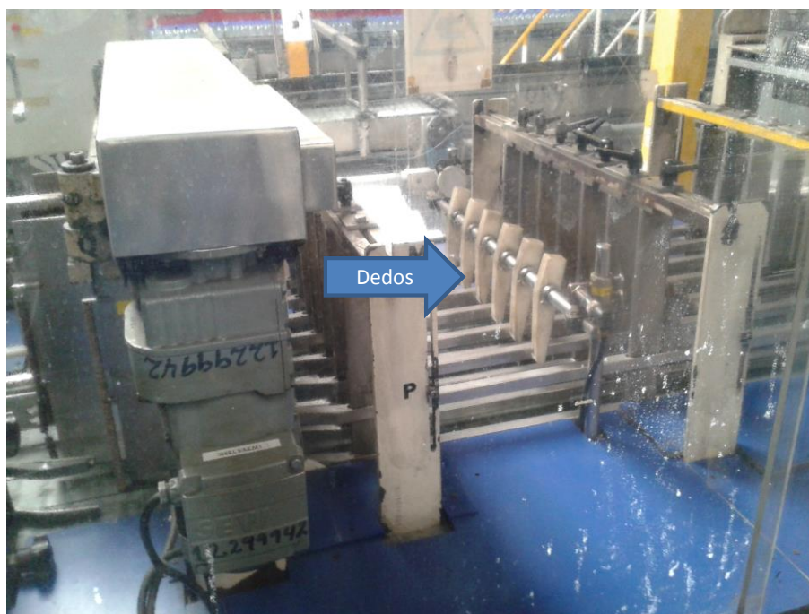
Figura 24: Agitador de botellas llenas o paredes móviles.
