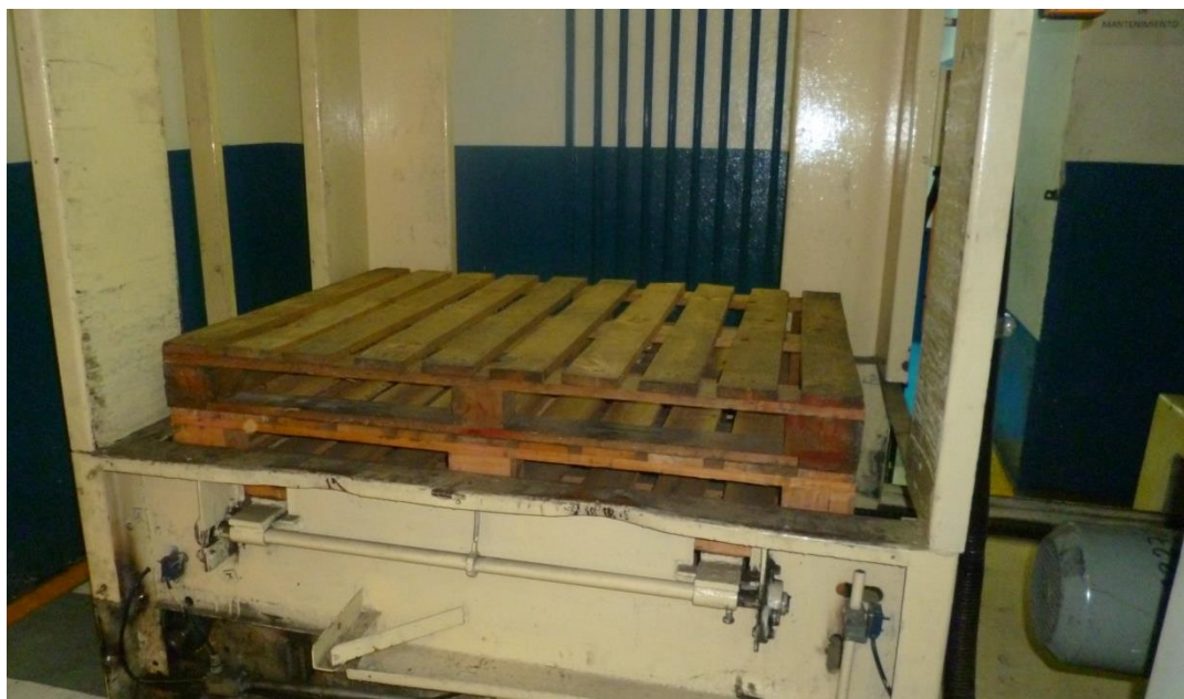
Figura 13: Arrumador de paletas vacías luego que han sido despaletizadas.
