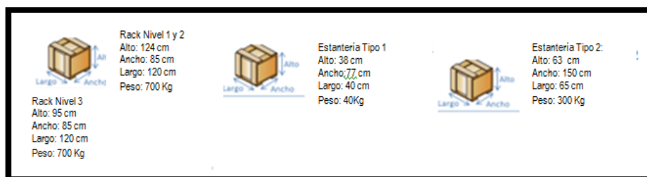
Dimensiones de los alvéolos y paletas en las diferentes estanterías
