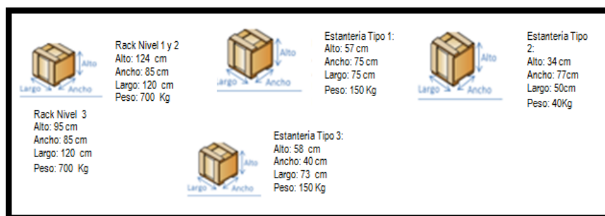
Dimensiones de los alvéolos y paletas en las diferentes estanterías
