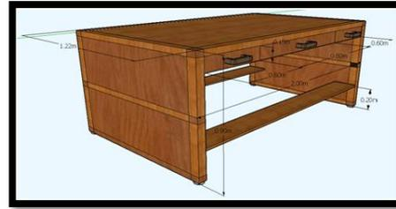
**Figura N° 35. Vista isométrica de la mesa de preparación de pedidos**
