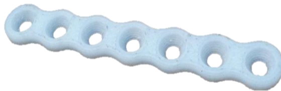
Figura 16: Impresión 3D de la placa en material nailon
