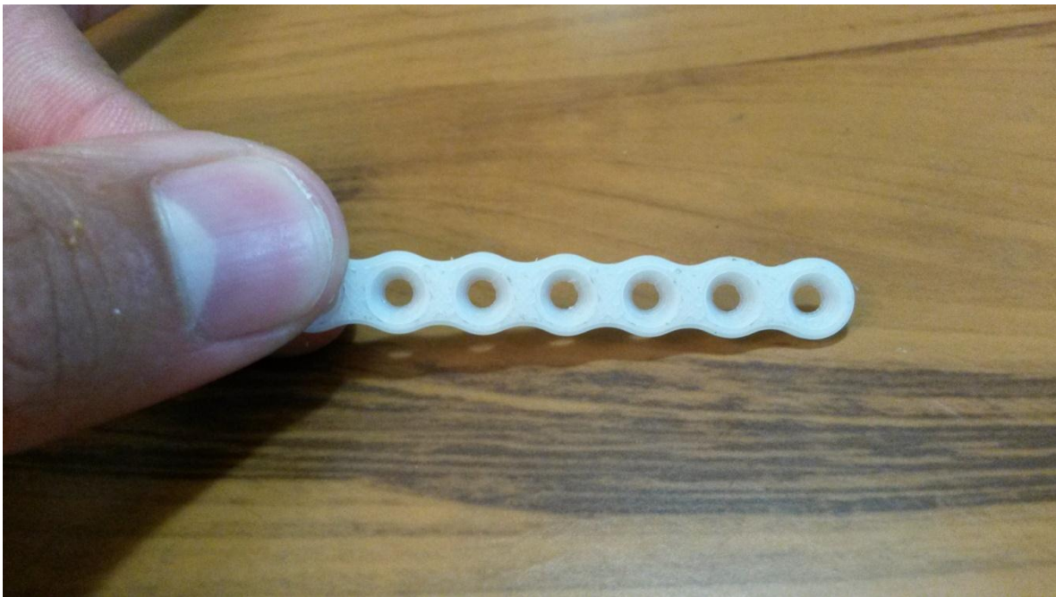
Anexo 9: Prototipado Rápido de la placa en nailon (Escala 1:1)
