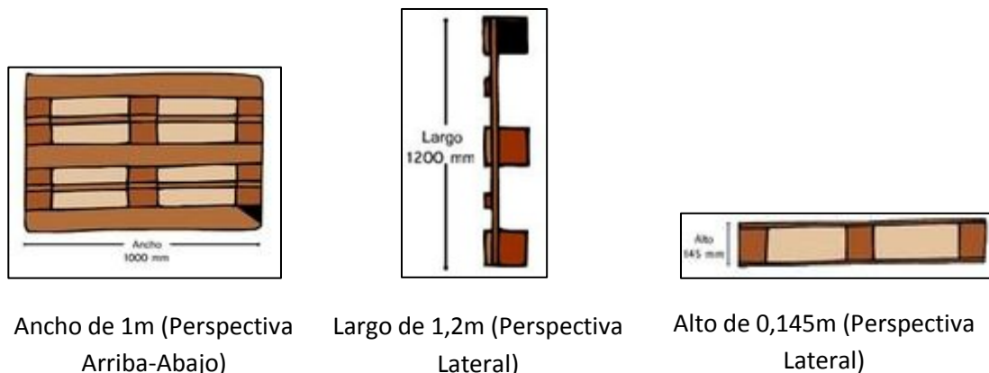
Figura N° 14: Especificaciones de la paleta a utilizar. Elaboración Propia (2014).
