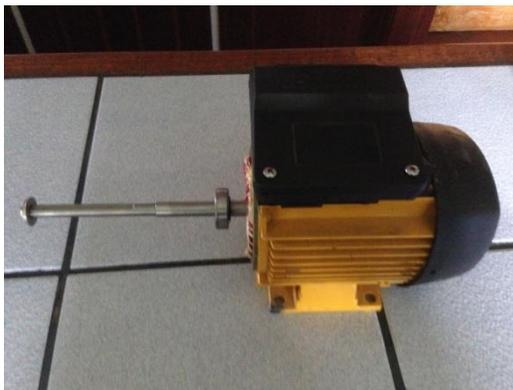
**Figure 14. Motor monofásico de 110-220 voltios con eje especial**
