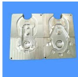
**Figure12. Molde para inyección de Plástico**
