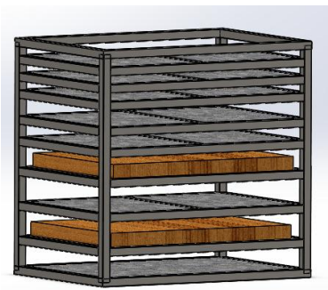
Figura 17. Vista 3D del Estante para Almacenar Láminas de MDF Fuente: Elaboración Propia
