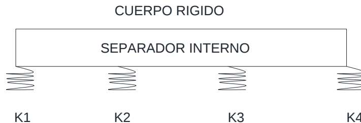
FIGURA 06-01. Modelo estructural del Separador Interno
