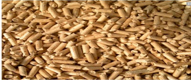
**Ilustración 2: Pellets de Madera.**
