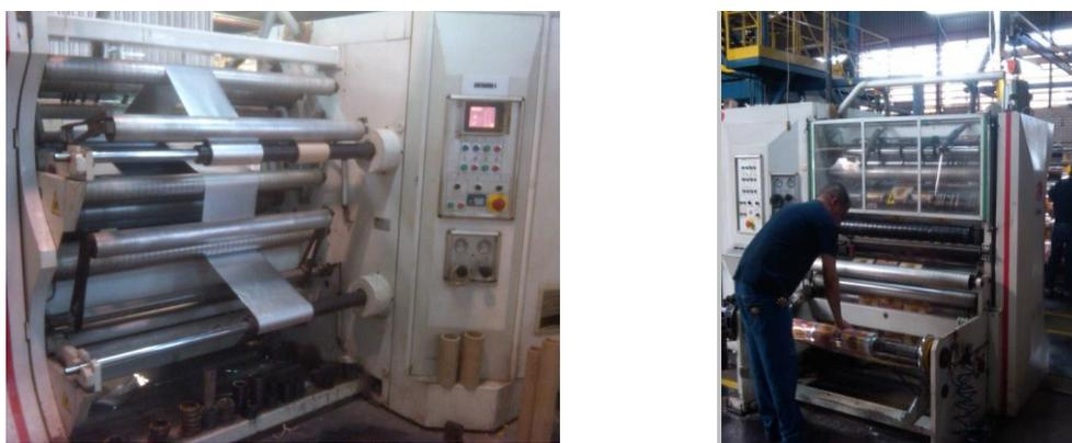
Figura 22. Equipo de corte y embobinado
