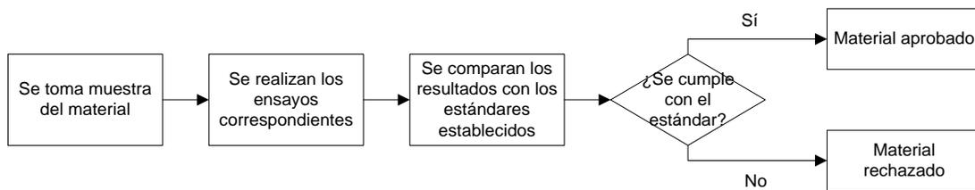
Figura 35. Diagrama del proceso de muestreo por parte de control de calidad
