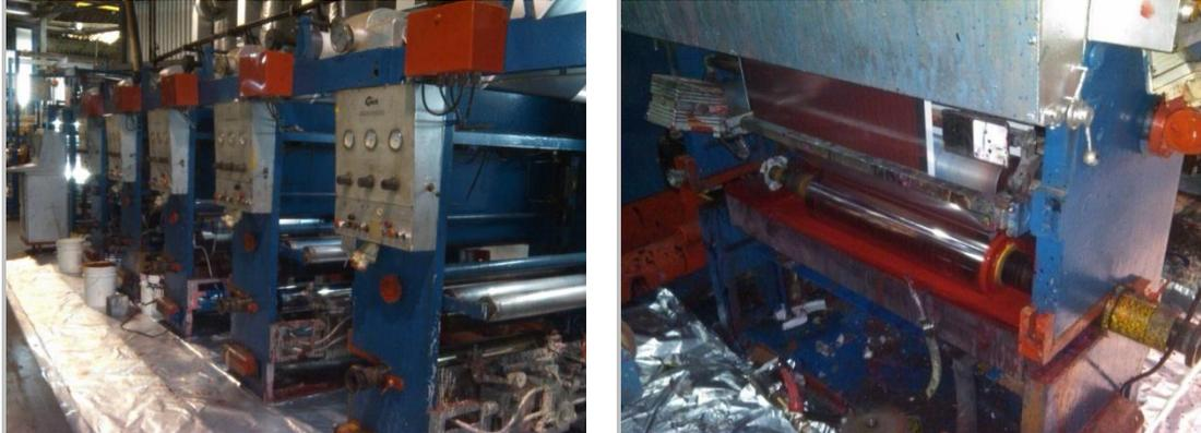
Figura 18. Equipo de impresión por rotograbado
