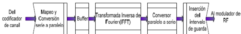
Figura 10. Diagrama de bloques del modulador OFDM
