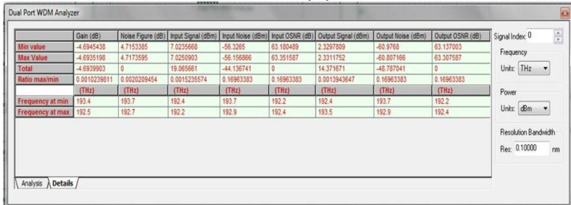
Figura IV-35 Estadísticas generadas por el analizador WDM dual (Simulación sol. mux. DWDM).
