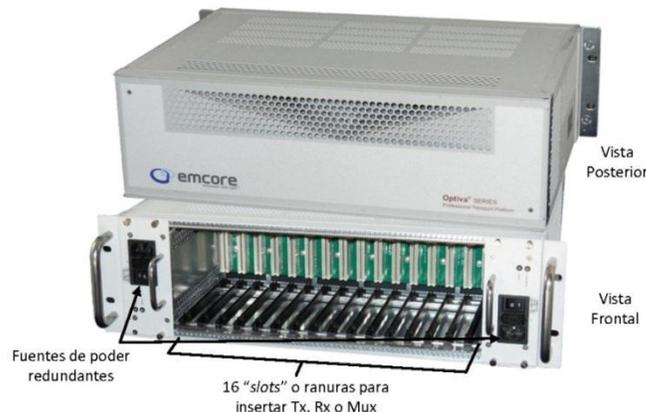
**Figura IV-2 Chasis de 3 RU y 16 ranuras (modelo: OT-CC-16F, marca: Emcore).
