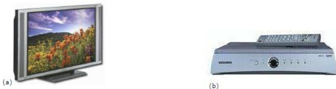
Figura 6. (a) Display con receptor integrado. (b) Receptor o conversor (Set top box).
