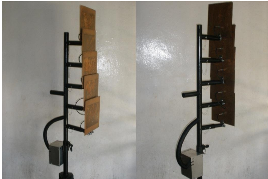
Figura 23. Arreglo en Configuración vertical. Fuente: Elaboración propia.
