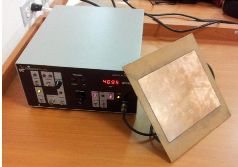
Figura 25. Transmisor empleado para la verificación del funcionamiento de las antenas. Fuente: Elaboración Propia.
