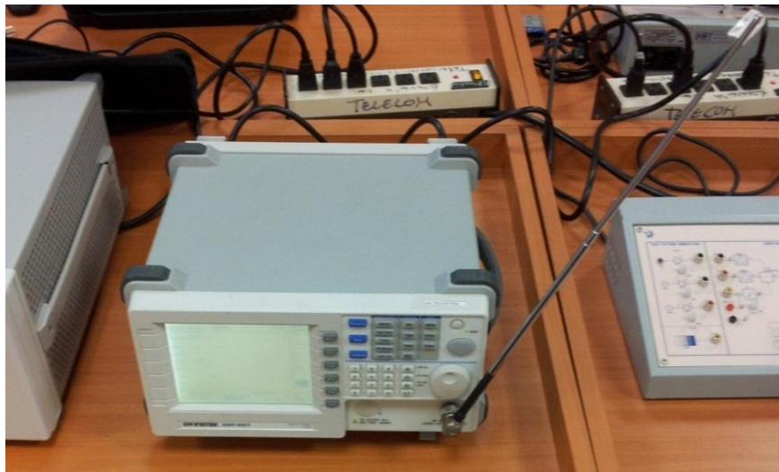
Figura 26. Analizador de espectro utilizado para captar las señales de prueba. Fuente: Elaboración Propia.
