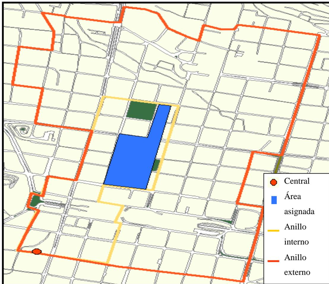
Figura 18. Tendido de anillos en la subárea.
