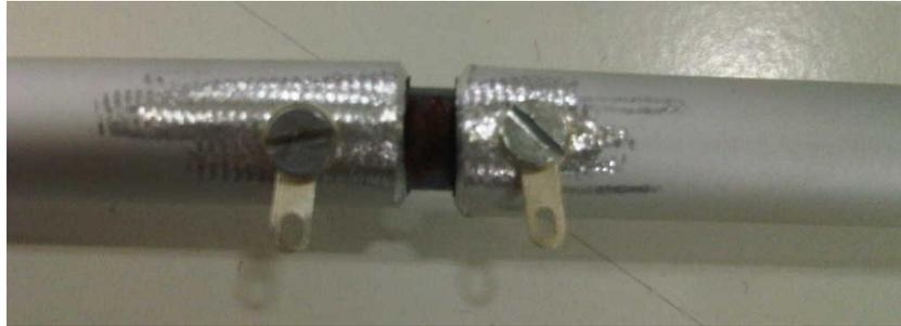
Figura 45. Dipolo ya armado, con punto de conexión lijados para aumentar la conductividad.
