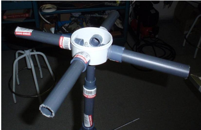
Figura 81. Cajetín con los tubos de PVC de 22cm que sumado todo da una distancia entre dipolos de un cuarto de longitud de onda.
