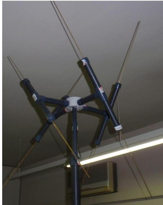
Figura 83. Antena DCA de dipolos de 3 milímetros.
