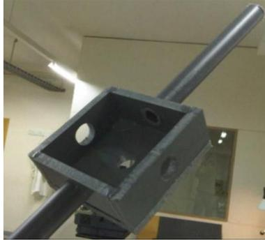
Figura 43. Caja armada y con los tubos de 20 cm colocados que hacen una distancia de un cuarto de longitud de onda.
