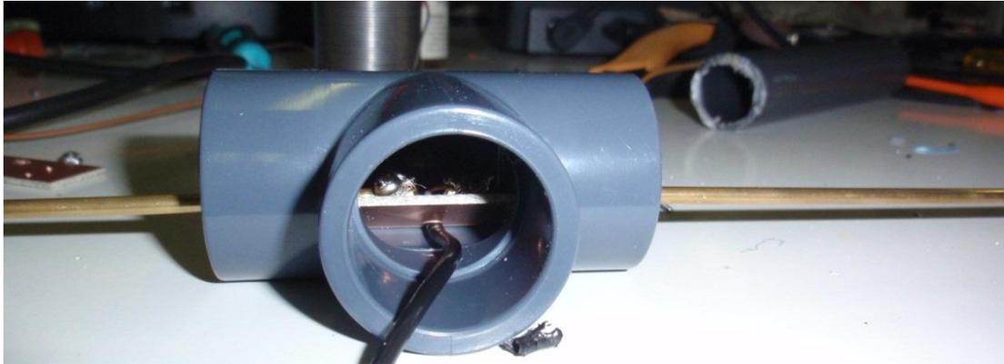
Figura 78. Introducir los dipolos dentro de la conexión T de material PVC.
