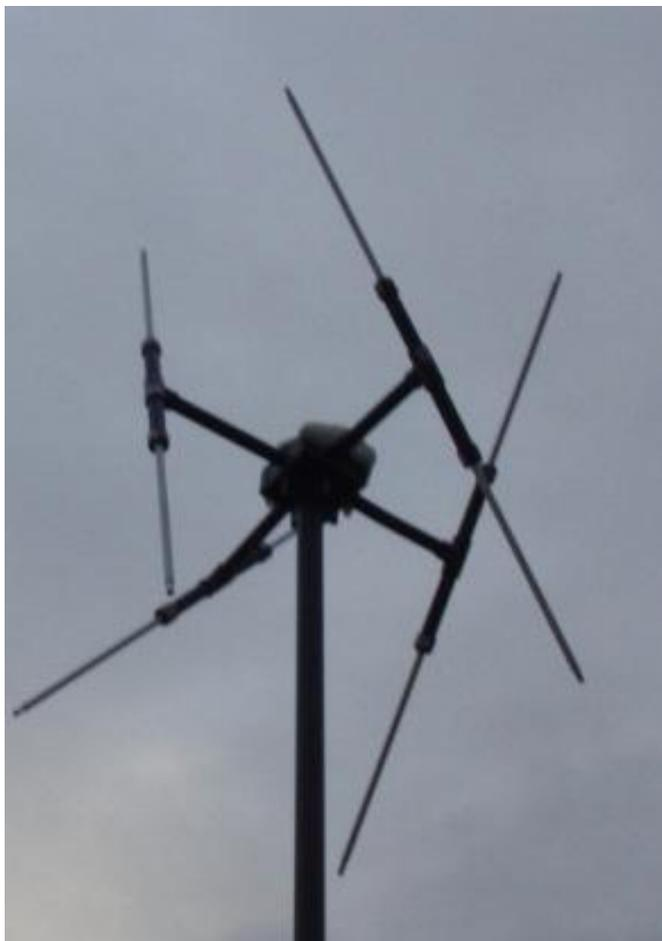
Figura 53. Antena Double Cross de dipolos de 12mm de diámetro.
