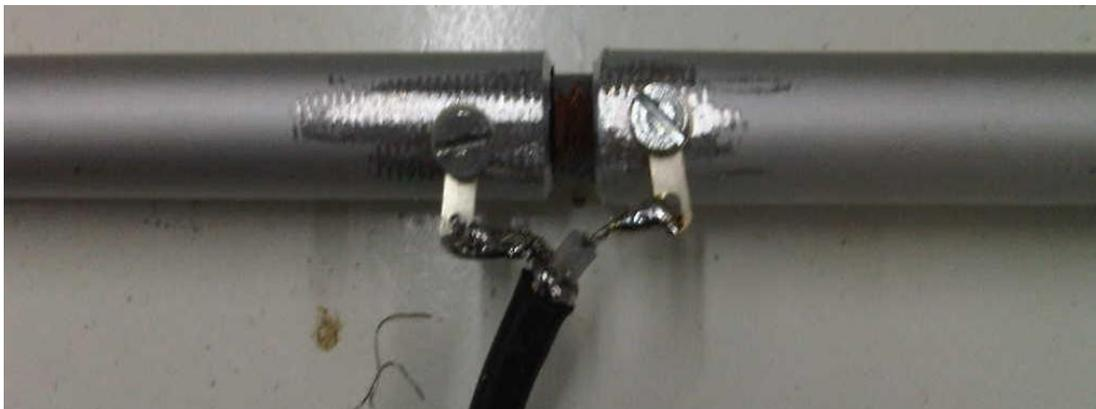
Figura 46. Conexión del cable coaxial al dipolo.
