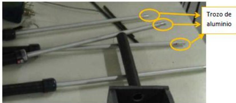
Figura 47. Dipolo con el trozo de aluminio que permitirá el cambio de longitud del mismo.
