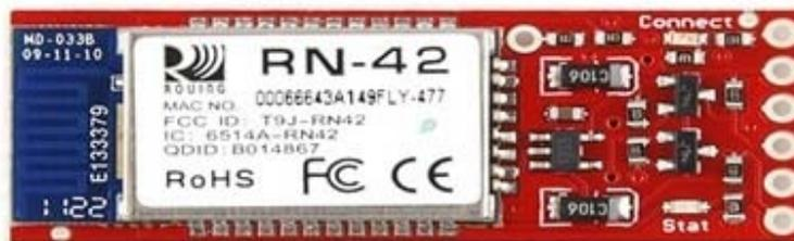
Figura 8. Blue SMiRF Silver (Vista Superior). Fuente: Sparkfun. (2012)
