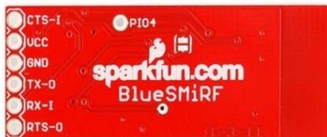
Figura 9. Blue SMiRF Silver (Vista Inferior). Fuente: Sparkfun. (2012)
