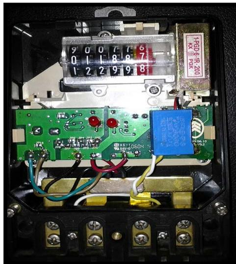
Figura 11. Medidor de consumo utilizado (Vista Frontal). Autoría Propia
