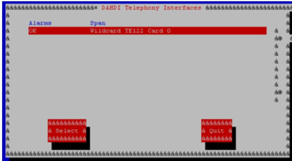
**Figura 41.** Estado de las Alarmas de la tarjeta digital Digium TE122.
