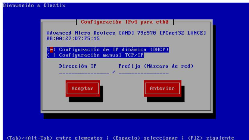
**Figura 7.** Selección del modo de configuración de las direcciones IP.
