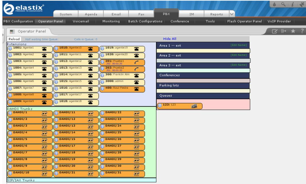
Figura 45. Estado de las llamadas activas a través del “Operator Panel”.
