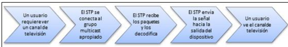
Figura 36: Diagrama de funcionamiento Set Top Box Fuente: (Propia)
