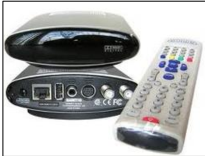
Figura 37: Set Top Box Amino AmiNET A125 Fuente: (Kurkino.TV, 2009)
