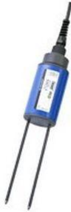
Ilustración 17: Sensor de humedad del suelo resistivo Fuente: [9]
