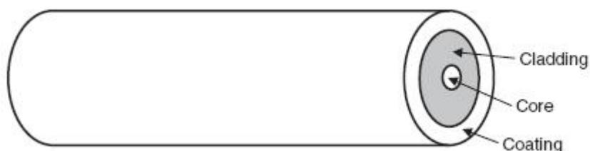
**Figura 1: Estructura básica de una fibra óptica**
