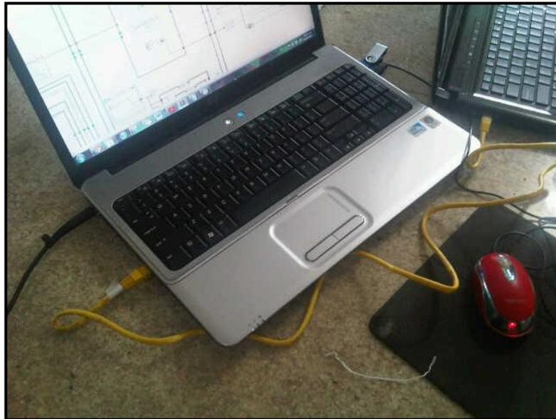
*Figura V.50: Conexión cableada mediante cable UTP CAT 5E.*
