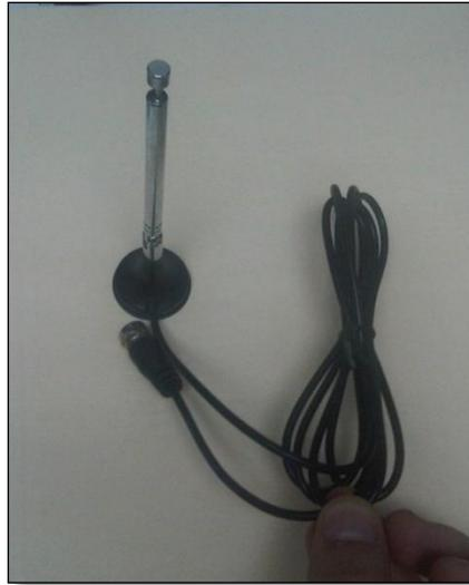
*Figura IX.3: Antena Incluida en los sintonizadores de TV Digital*
