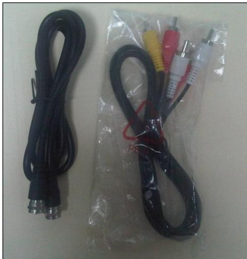
*Figura IX.4: Conectores incluidos en los sintonizadores de TV Digital*
