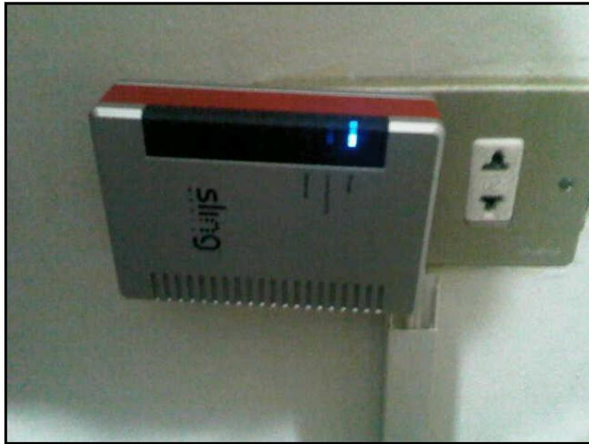
*Figura V.51: Conexión del CPE al tomacorriente.*
