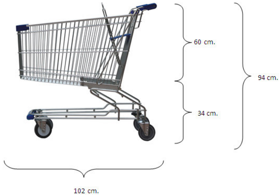
Figura 16. Medidas de una carrito de supermercado de Plan Suárez (Fuente Propia)
