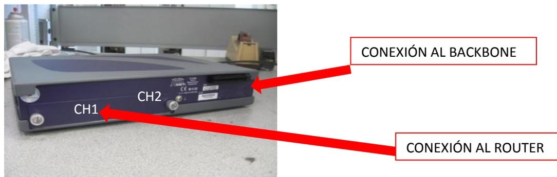
**Figura 2. 2:** Diagrama de conexión al router correspondiente y al Backbone del equipo ACTERNA. Fuente: Investigación Web.
