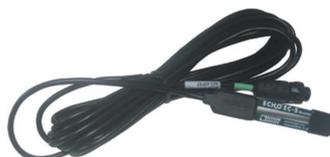
**Ilustración 5. Sensor que medie el contenido de agua en el suelo.**
