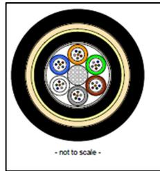
**Ilustración 45. Corte del cable de fibra óptica seleccionado. Fuente: (DRAKA, 2009)**
