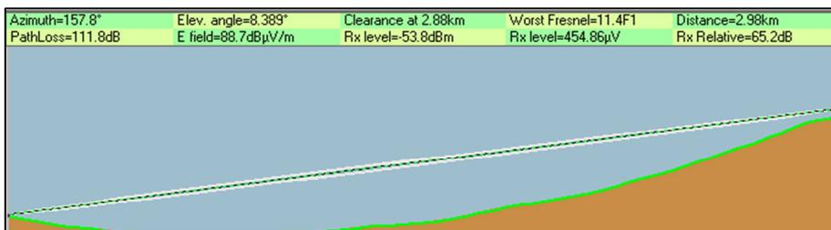
**Ilustración 33. Línea de vista La Trinidad-R1. Fuente: Propia.**
