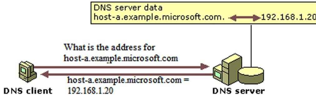
**Figura 5. Funcionamiento básico de un sistema DNS.**
