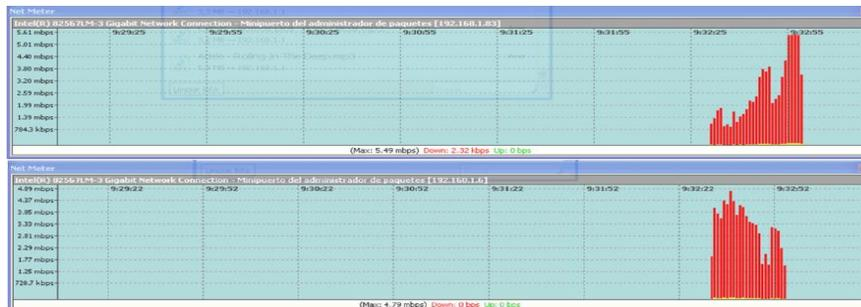
Figura 46. Descarga de un archivo desde la LAN 2, utilizando dos DSLAM.
