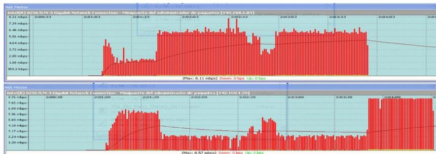
Figura 58. Descarga de un archivo desde la LAN 2, utilizando dos DSLAM.
