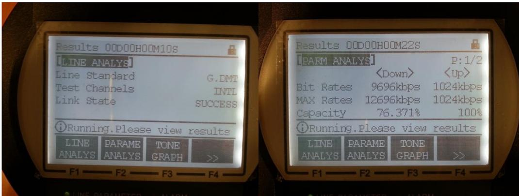
Figura 27. Tester ADSL2+ estándar G.DTM
