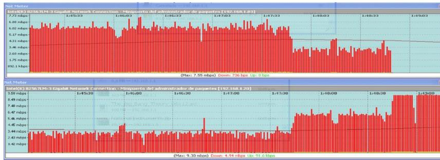
Figura 56. Descarga de un archivo desde la LAN 2, utilizando un DSLAM.
