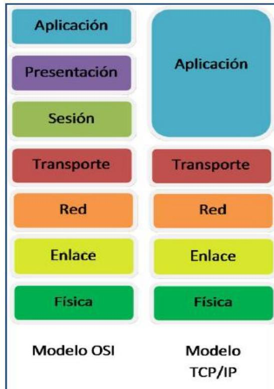
**Ilustración 7 Modelo OSI vs. Modelo TCP/IP**
