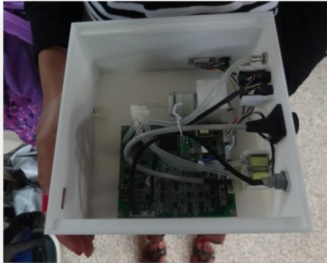
**Fotografía 7 Caja con Tarjeta multiparamétrica instalada**
