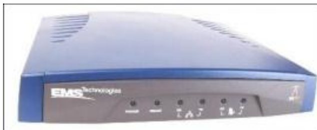
Figura 12 Vista frontal de una IDU.
