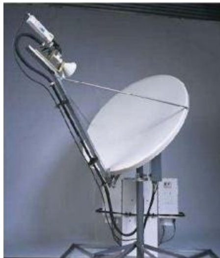
Figura 11 Fotografía de una ODU de una estación VSAT.
