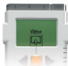
En el Menu "View" podemos obtener datos de los sensores y motores. (Se deben colocar los motores y sensores en los puertos que se nos indican correctamente).
