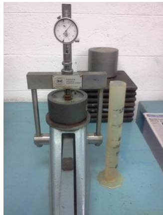
Figura N° 13: Proceso de consolidación con la muestra inundada. Fuente propia
