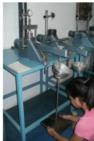
Figura N° 14: a) Proceso de carga en la calibración. b) Ajuste del equipo. Fuente propia.
