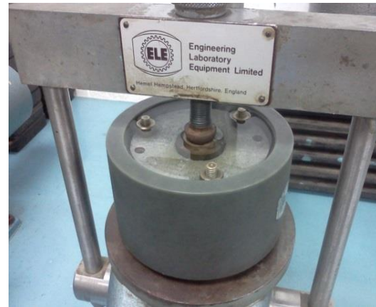
Figura N° 13: Proceso de consolidación con la muestra inundada. Fuente propia
