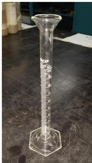
**Figura 17.** Cilindro Graduado.
