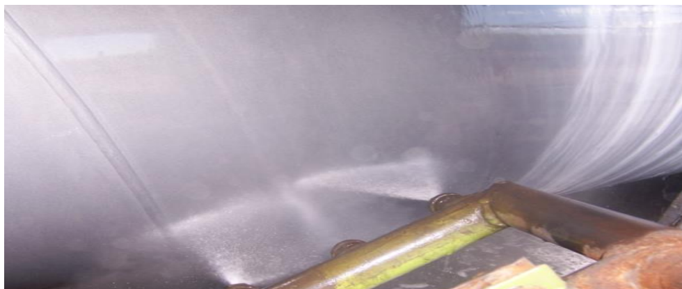
Figura 10: Lavado con agua desmineralizada. Fuente: Manuales de PGJAA
