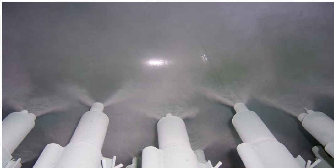
Figura 15: Inyectores rociadores de la resina en polvo. Fuente: Manuales de PGJAA
