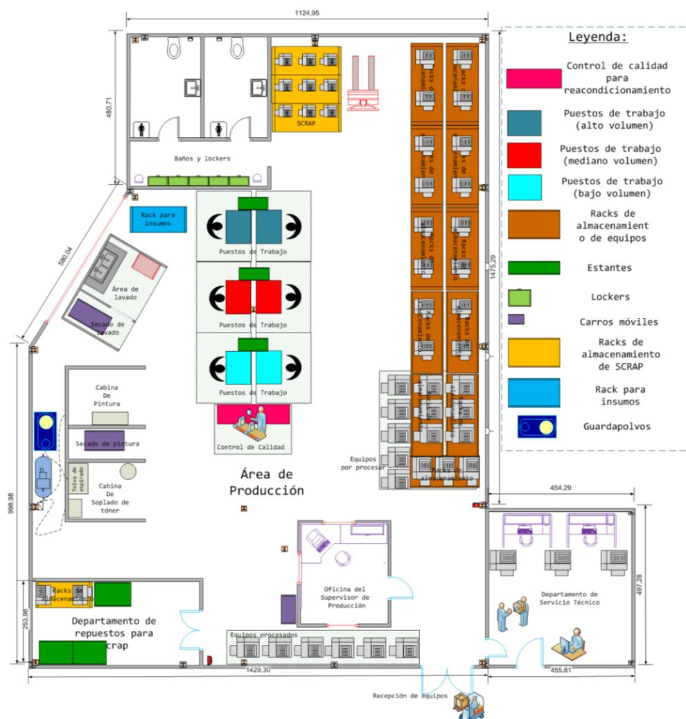
Figura N° 41: Plano de distribución (layout) propuesto para el departamento de producción.
