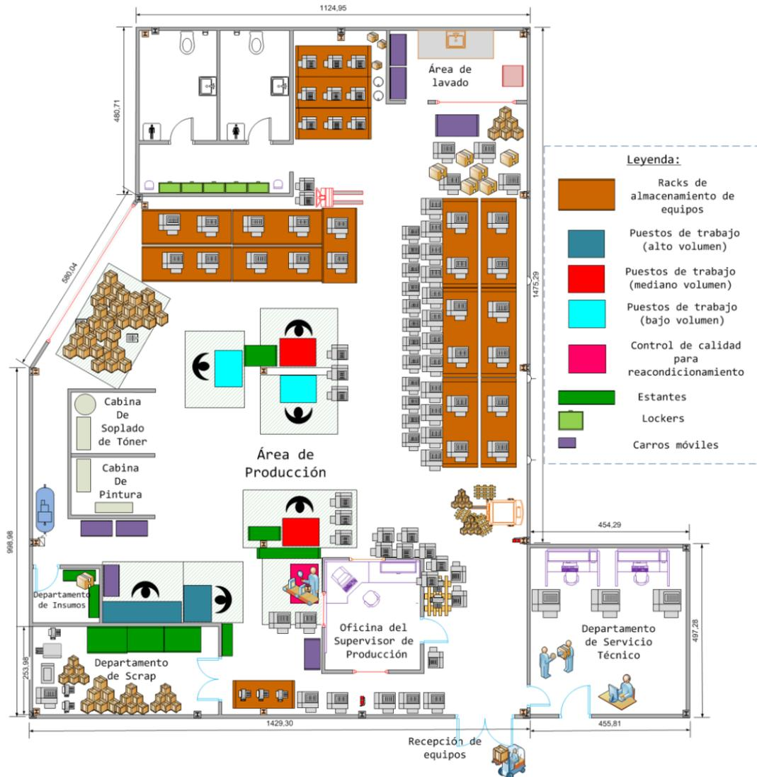
Figura N° 18: Distribución física actual en el área de producción.
