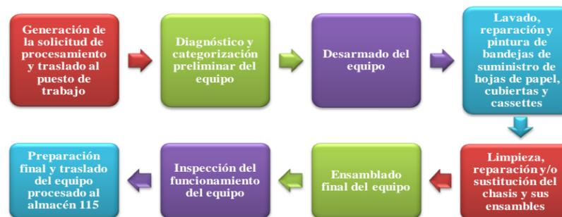
**Figura N° 15: Diagrama de bloques de equipos reacondicionados.**
