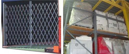
**Figura N° 53: Rejas tipo acordeón propuestas para los niveles inferiores y Barandas propuestas para los niveles superiores de las estanterías estructurales.**
