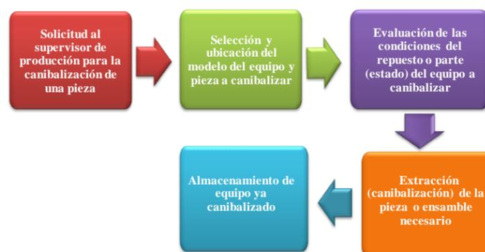
**Figura N° 16: Diagrama de bloques de canibalización de equipos.**
