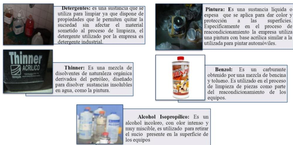
Figura N° 13: Materiales utilizados para el reacondicionamiento de máq. de impresión y copiado
