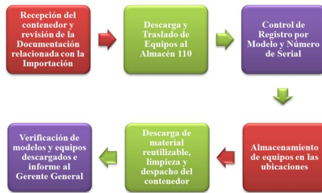
**Figura N° 14: Diagrama de bloques del proceso de recepción, descarga y almacenamiento de equipos usados.**
