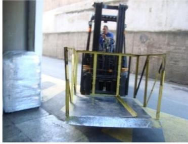
**Figura N° 26: Montacargas y cesta del montacargas.**
