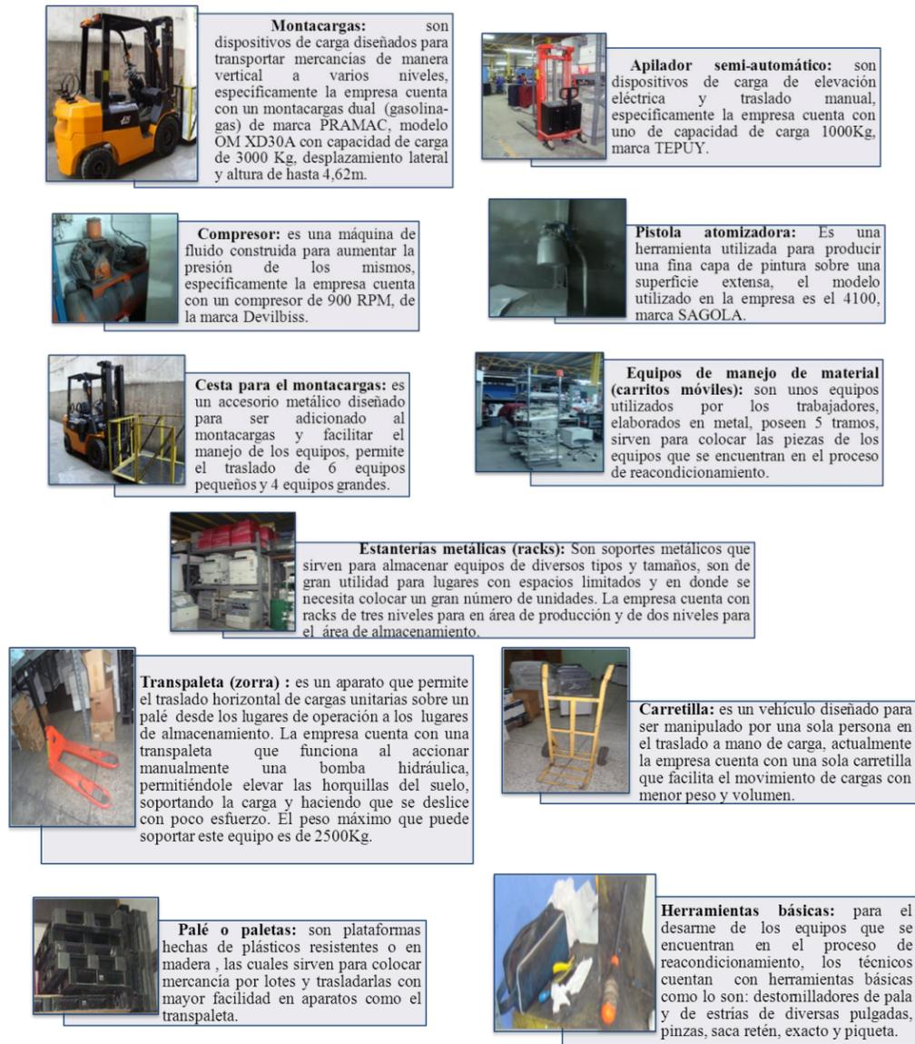
Figura N° 12: Herramientas y equipos utilizados para el reacondicionamiento de máquinas de impresión y copiado.
