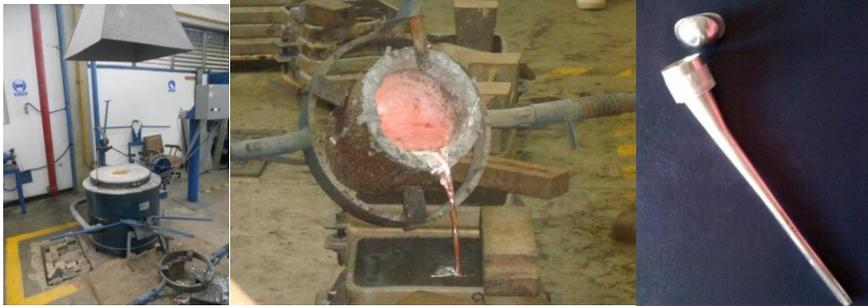
Ilustración 3 Prototipo fundido en arena. Fuente: Elaboración propia
