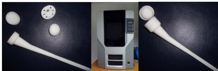
Ilustración 2 Prototipo en nailon Fuente: Elaboración propia
