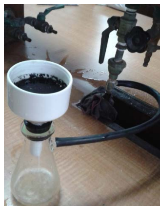
Figura 16 Uso del embudo Büchner para el filtrado de la muestras
