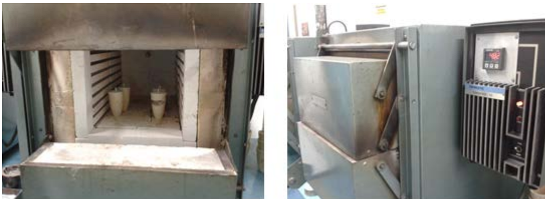
Figura 13 Muestras en la mufla a 482°C
