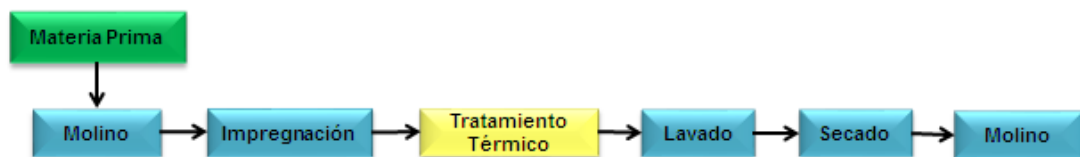
Figura 3 Esquema general del proceso de obtención de carbón activado por activación química
