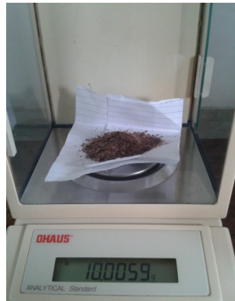
Figura 11 Peso de una de las muestras de cáscara de cacao en la balanza monoplato
