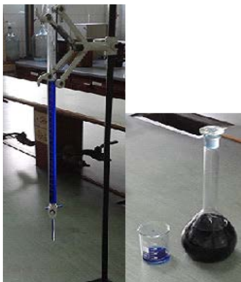
Figura 21 Medición de azul de metileno por cada muestra de compuestos
