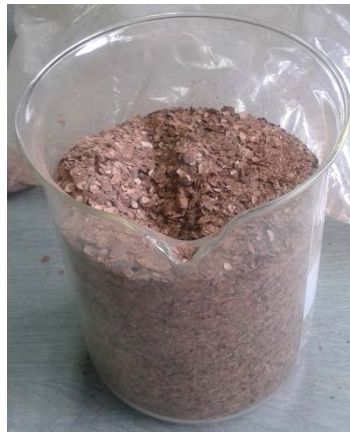
Figura 10 Cáscara de cacao luego de ser triturada con un molino
