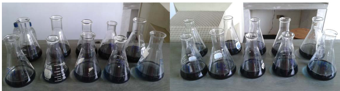
Figura 22 Muestras de solución con gramos de carbón activo
