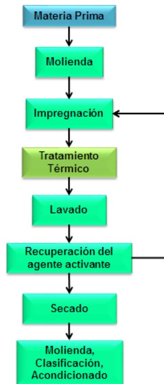
Figura 2 Diagrama del proceso de producción mediante Activación Química
