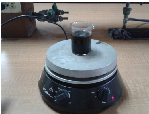
Figura 15 Lavado de las muestras con un agitador magnético
