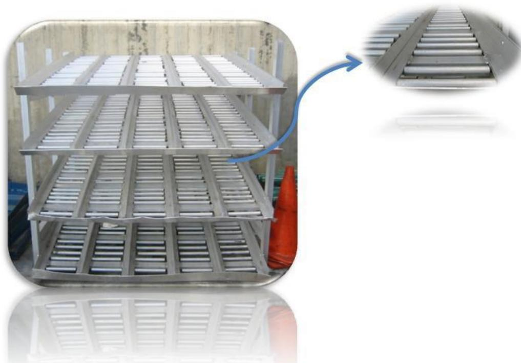
Figura 28 Anaquel diseñado para el almacenamiento de productos en el Área de Canje
