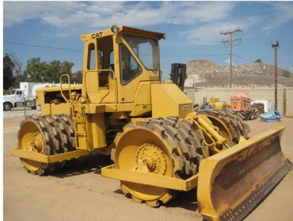
**Figura 5. Compactadora “Pata de Cabra”**
