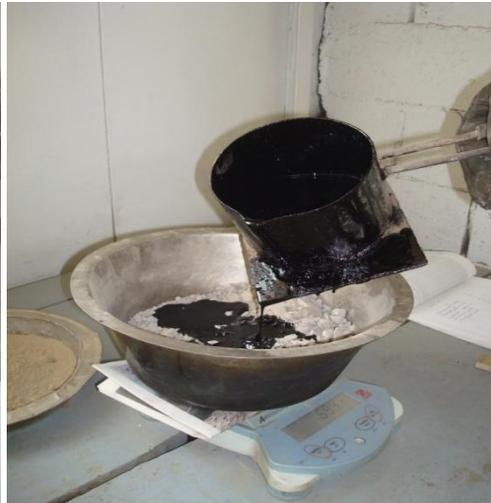
Pesaje del Cemento Asfáltico
