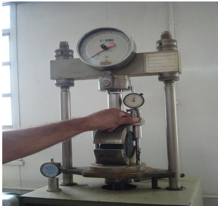
Prensa MARSHALL y Fluxómetro
