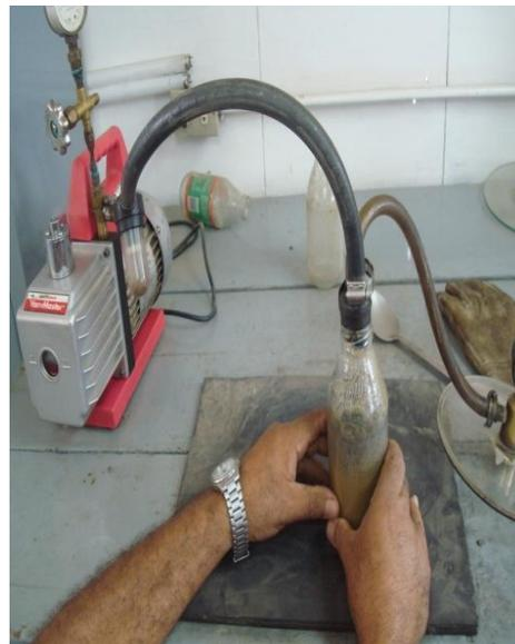
Ensayo de Peso Especifico
