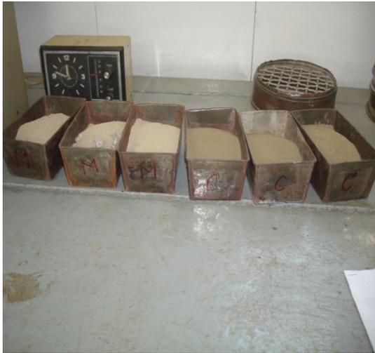
Pesadas para el Ensayo RICE
