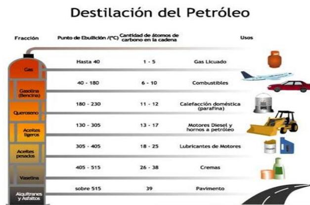
Figura 1: Temperaturas aproximadas de separación del crudo.
