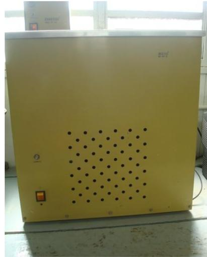
Briquetas Sumergidas a 60°C
