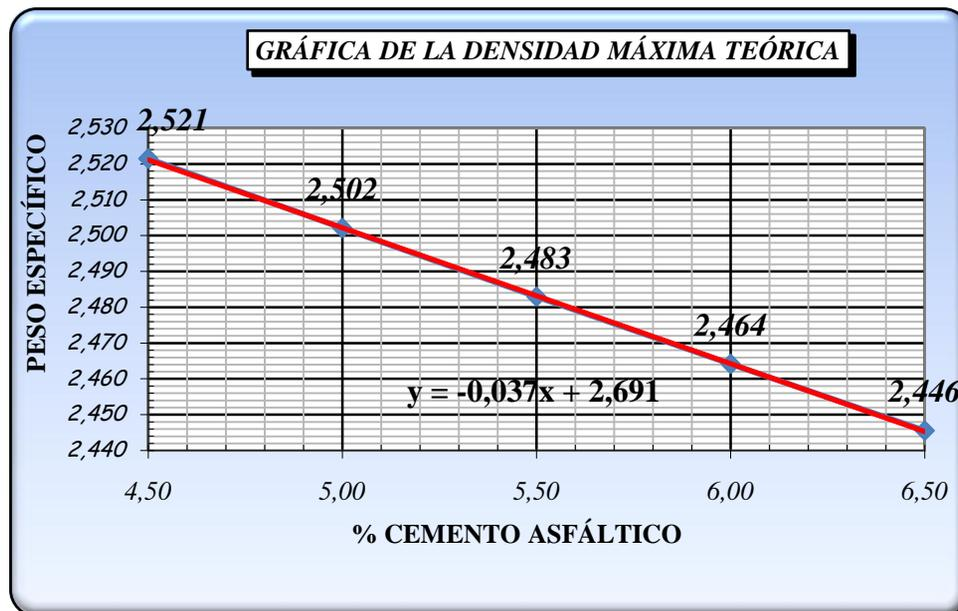
Gráfico 2: Densidad Máxima Teórica con agregado de Cantera para los diferentes porcentajes de cemento asfáltico
