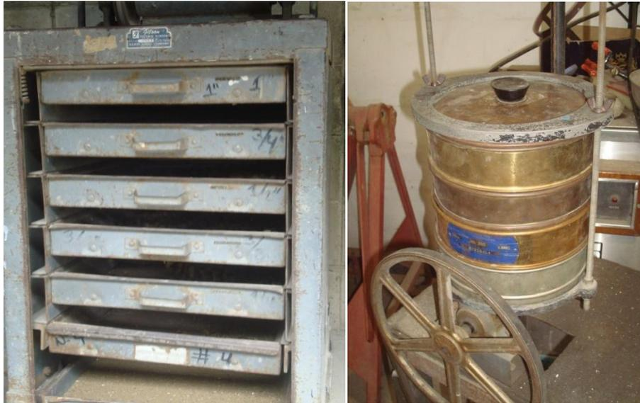
Tamizadora Eléctrica Agregado Grueso Tamizadora Eléctrica Agregado Fino
