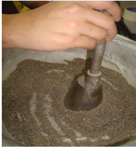
Agregado Saturado con Superficie Seca
