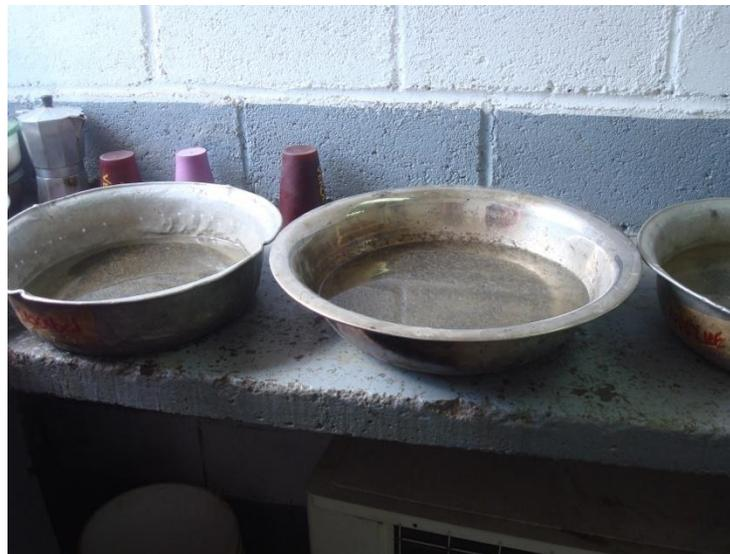
Agregados sumergidos por 24 horas para Peso Especifico
