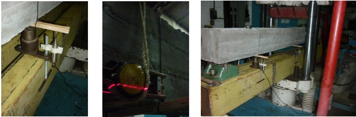
Figura 3.8.- Colocación de deformímetros
