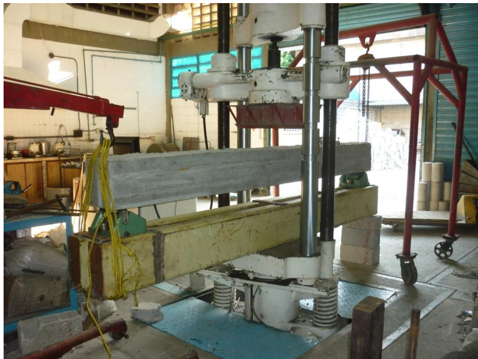
Figura 3.9.- Colocación final de especímenes para ser ensayados
