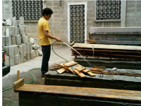
Figura 3.5.- Proceso de curado de los especímenes.
