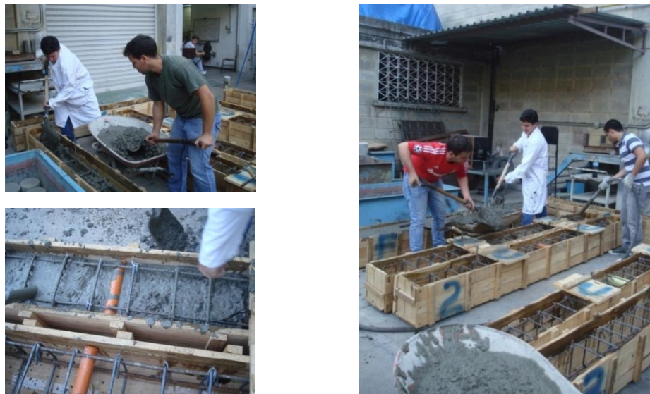
Figura 3.4.- Proceso de vaciado de los especímenes
